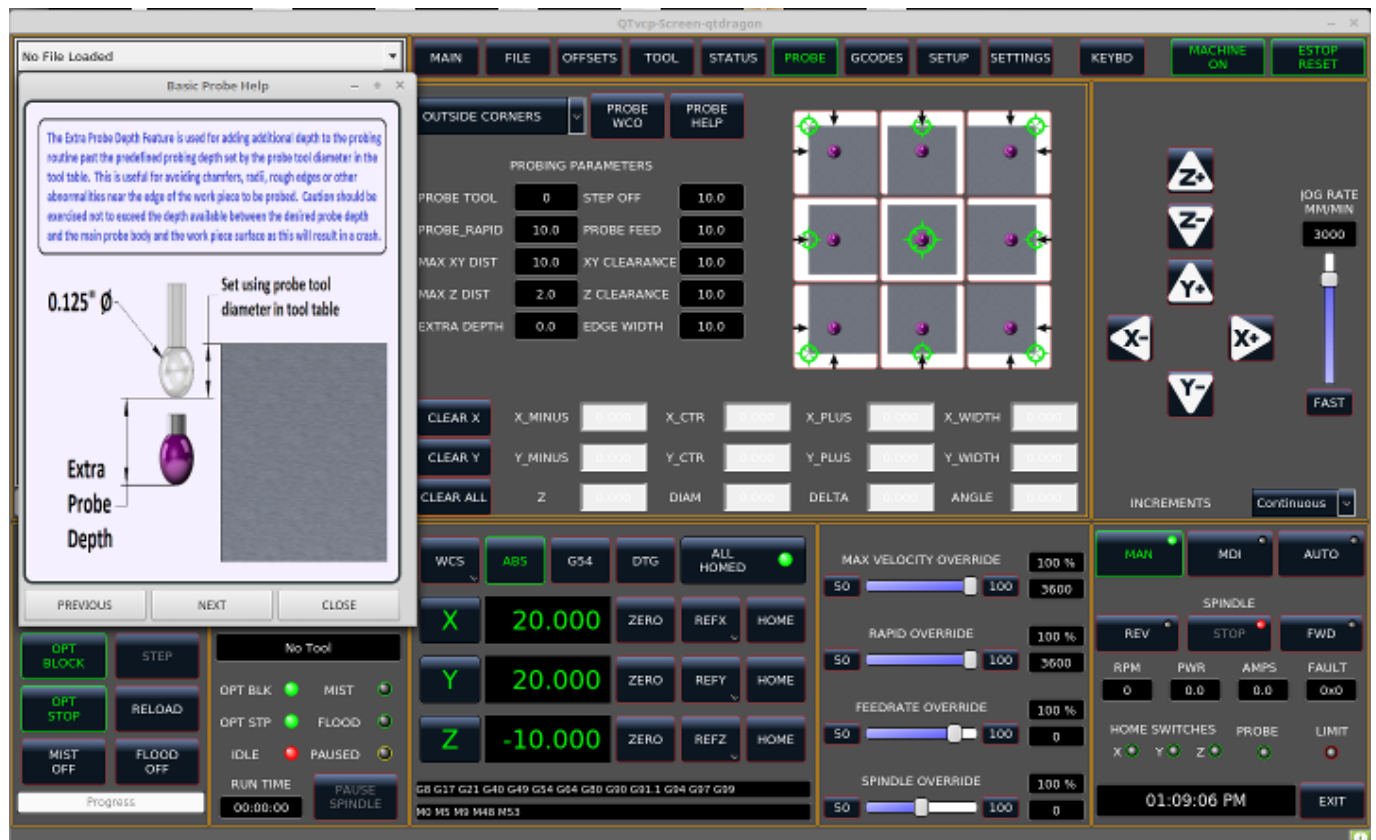
Abbildung 10.34: QtDragon - Grundlegende Sondenoption
