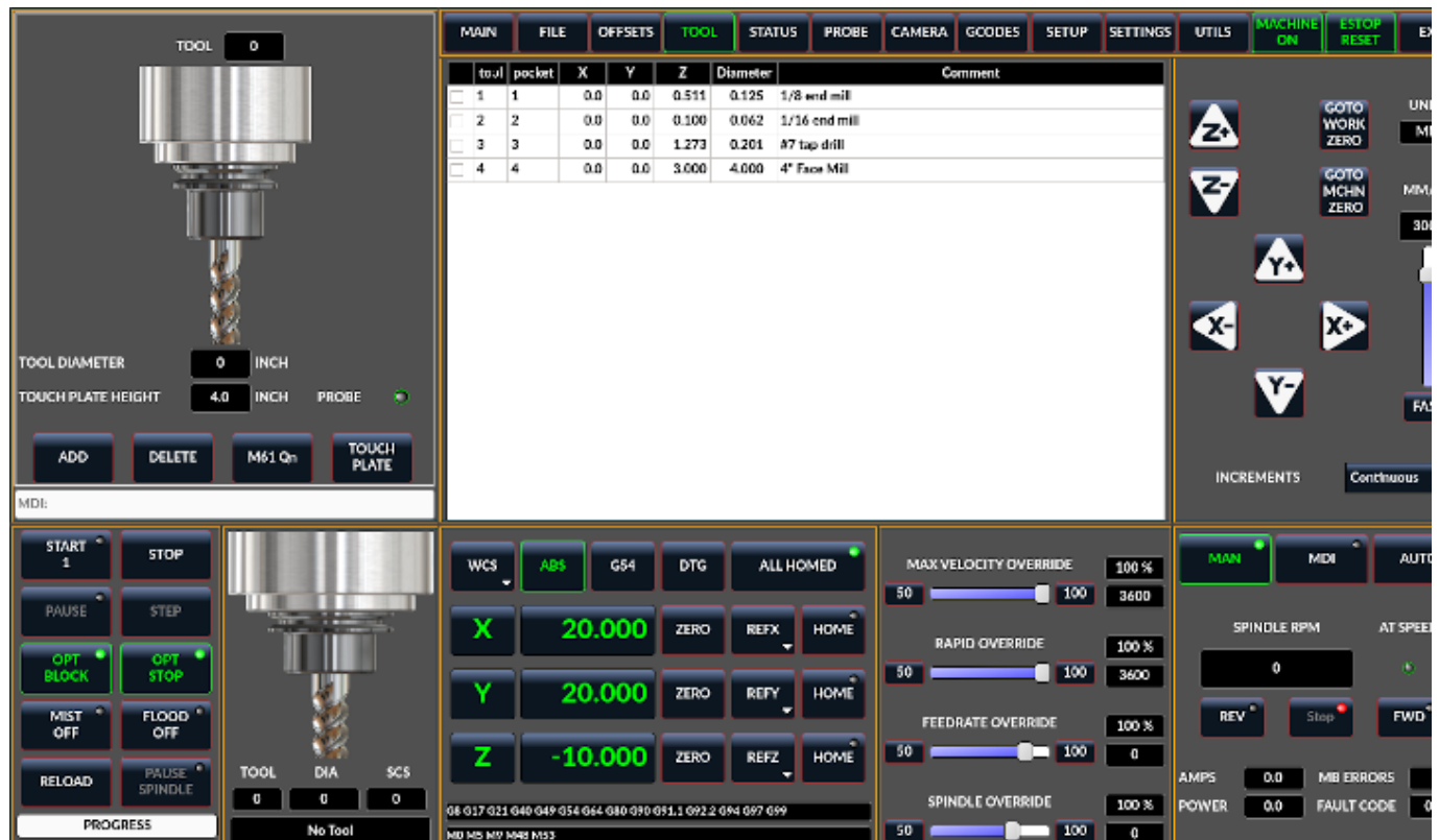
Abbildung 10.35: QtDragon Touch-Fläche (engl. touch plate)
